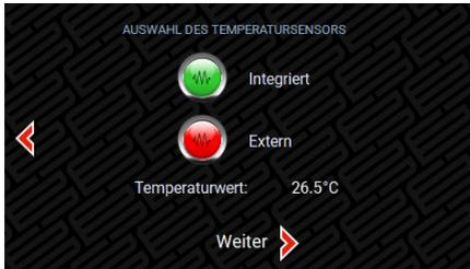
Der nächste Schritt ist die Auswahl des Temperatursensors, der als Master-Sensor in den Steueralgorithmen dienen soll.
