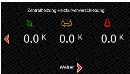
Der Modus "Temperatureinstellung" dient zur direkten Einstellung der Soll-Temperatur im ZH-Modus für die Modi Economy, Comfort und Pre-Comfort. Sowohl im Modus "Heizkurve" als auch im Modus "Temperatureinstellung" werden dann drei feste Warmwassertemperatur-Sollwerte eingestellt.
