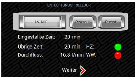
Wenn keine Entlüftung durchgeführt wurde, wählen Sie die Option "Entlüftungsvorgang". Nach Auswahl des Feldes "START" läuft die Umwälzpumpe in folgenden Zyklen:
