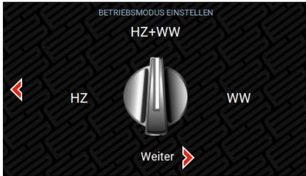
Sobald das Kurbelgehäuse des Kompressors aufgewärmt ist, wählen Sie den Modus, in dem die Wärmepumpe betrieben wird. Sie haben die Wahl zwischen drei Modi:
