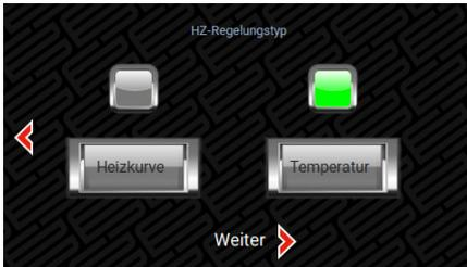
Anschließend muss das Regelverfahren der Wärmepumpe eingestellt werden. Es stehen zwei Modi zur Verfügung: Heizkurve und Temperatureinstellung.
