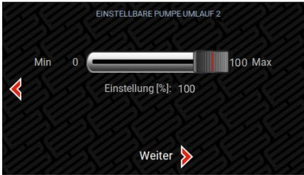
Wurden zwei Heizkreise ausgewählt, wird im folgenden Fenster der feste Betriebswert der Umwälzpumpe des zweiten Heizkreises in Prozent eingestellt.
